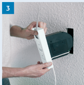
RolloTron einbauen
