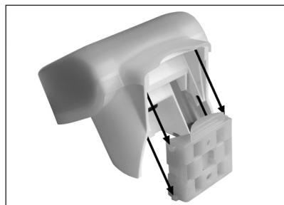
Schuif de behuizing van boven in de gemonterde houder. De pennen van de houder moeten daarbij in de rails van de behuizing vastklikken.
