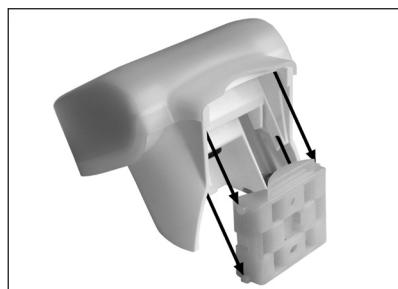
Poussez le boîtier sur le support monté par le haut. Les ergots du support doivent ici s'enclencher dans les rails du boîtier.
