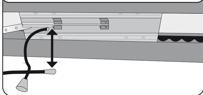
**7** Bowdenzug in die Bowdenzug-Hülle einführen und anschließend das Seil mit dem Kugelkopf in die Öffnung im Schlitten einhaken.
