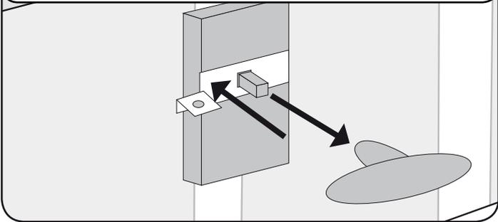
**2** Torgriff wieder montieren. Drehrichtung Tor öffnen prüfen. Der Winkel muss nach unten drehen.
