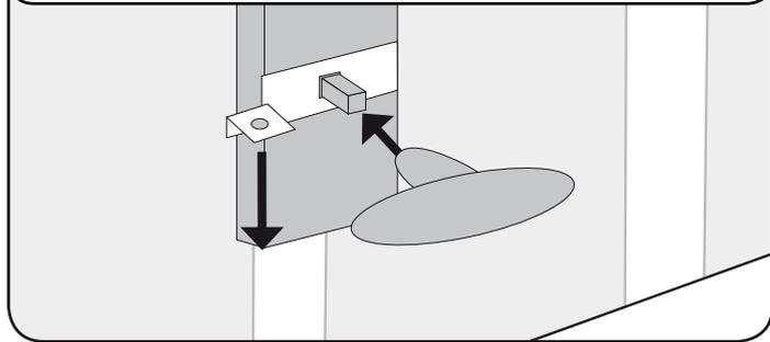
**3** Winkel für Bowdenzug an Torquerstrebe befestigen. Achten Sie darauf, dass die beiden Bohrungen übereinander liegen.
