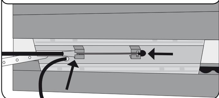
**8** Bowdenzug mit Seilklemme unter Winkel arretieren. Anschließend Probefahrt durchführen. Erst danach überstehende Seillänge passend einkürzen.
