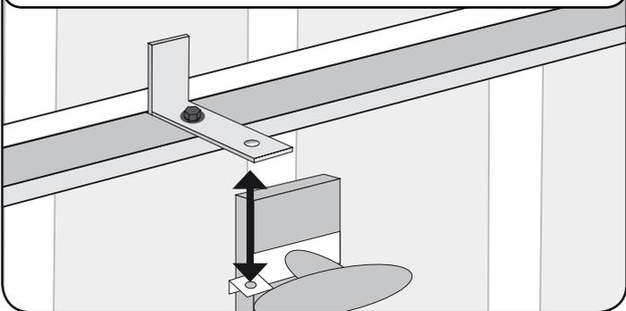
**4** Bowdenzug-Hülle mittels U-Scheibe und Mutter befestigen.
