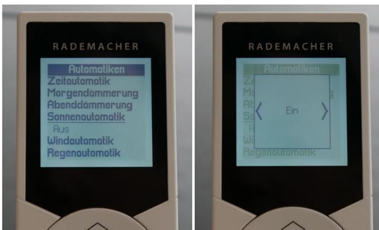
8. Sobald die Funktion eingeschaltet ist, wird ein kleiner Pfeil angezeigt. Tippen Sie die Taste rechts, um weitere Einstellungen für die gewählte Automatik vorzunehmen. Bei Sonne legen Sie die Sonnenposition für das jeweilige Gerät fest, bei Wind und Regen wird die Fahrtrichtung festgelegt.
